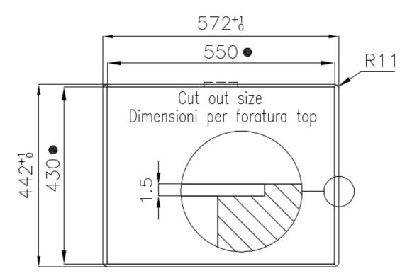
Built-in cut out for FTS - Foratura per installazione FTS
