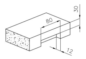
intaglio per il troppo-pieno solo con top > 30 mm recess for housing the over-flow only for top > 30 mm
